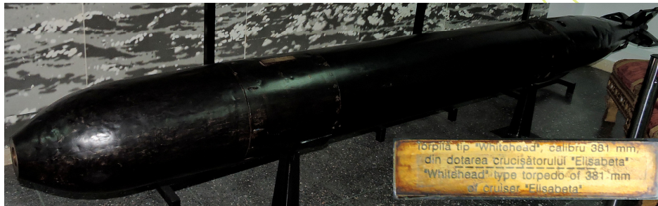
Fig. 1.4. Torpila Whitehead de la Muzeul Marinei Române din Constanța; calibrul 381 mm înseamnă de fapt 15 inch
